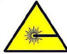
خطر پرتو لیزر Danger Laser Beam
